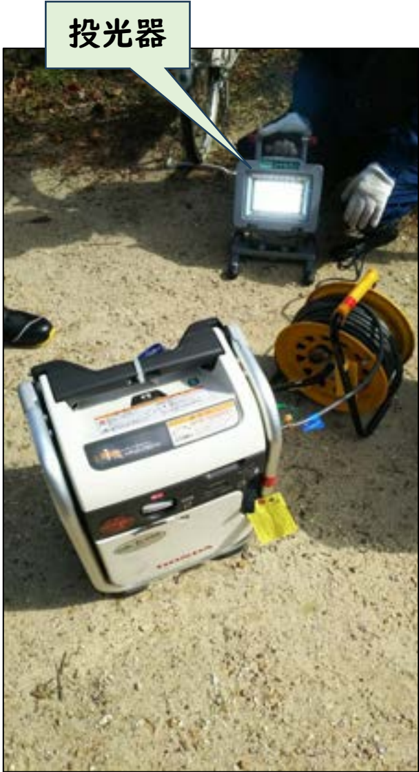
コードリールに発電機と投光器 をつなぎ点灯させる
