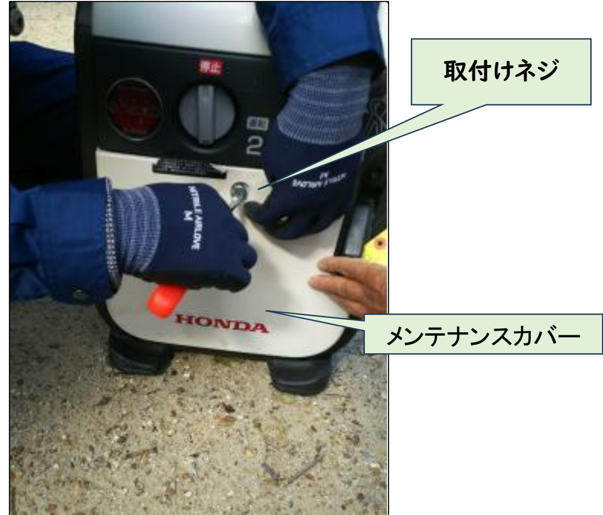
確認後、取り外したメンテナンスカバーを取り付ける
