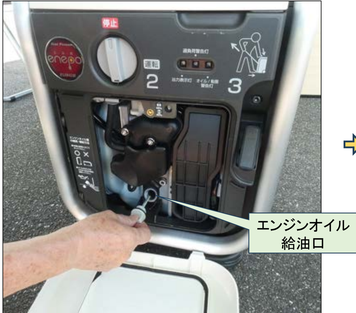
メンテナンスカバーを取り外しエンジンオイルを確認する
