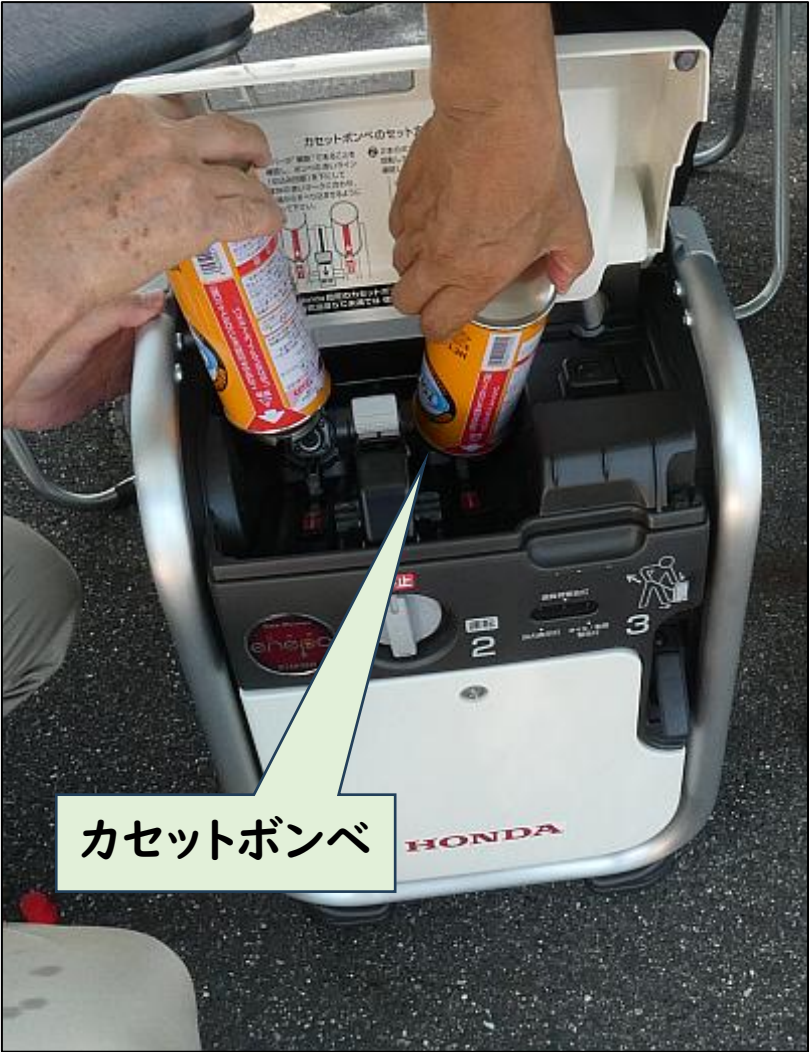
カセットボンベ(2本)の溝を下にして 装填する
